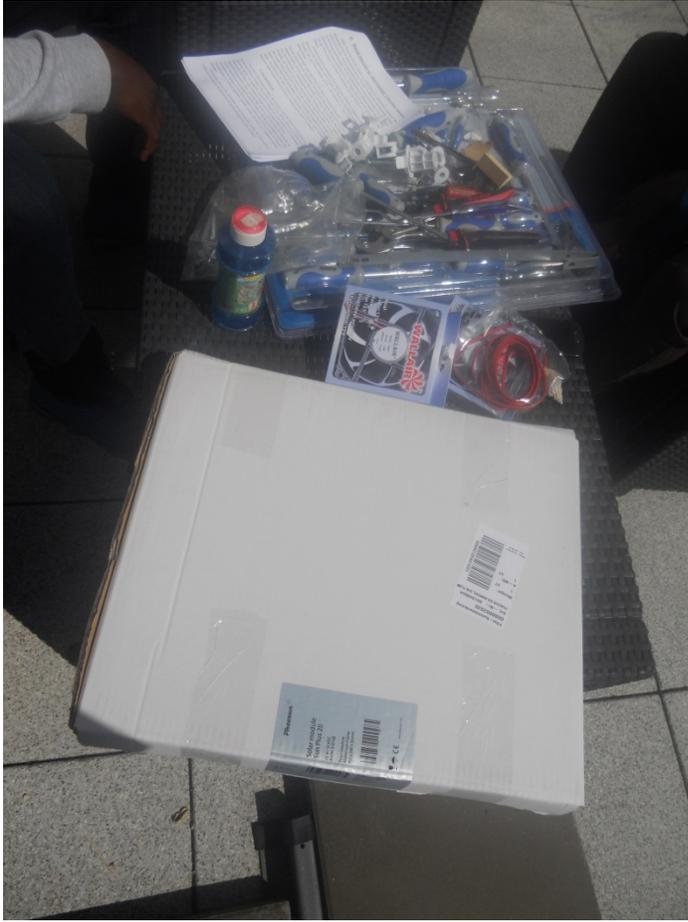
**Photo 1: Matériel nécessaire (1 Module solaire, 2 m de fil électrique (2 x 0,5 mm<sup>2</sup>), 1 ventilateur de 12 Volt, diamètre 100 mm, vis, écrous, divers, outils)**
