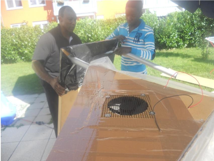
**Photo 15: Pose de la surface d'absorption sur la table de séchage.
